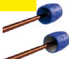
Limpiar interior y exterior del tubo con un escariador
