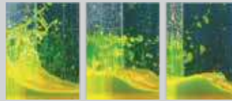
Oscilaciones sin compensador
